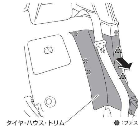
**9-3.** 図に示す矢印の方向にタイヤ・ハウス・トリムを動かし、クリップおよびガイドとボデー・パネルのかん合を外す
