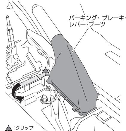
**6-2.** 図に示す矢印の方向にリムーバ・ツールを動かし、リヤ・コンソールとクリップのかん合を外す
