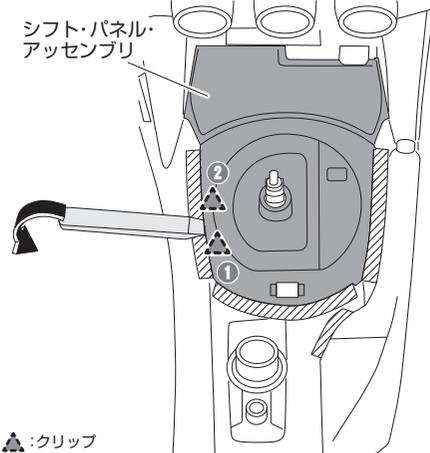
**4-7.** 図に示す矢印の方向にシフト・パネル・アッセンブリを動かし、ガイドを取り外す
