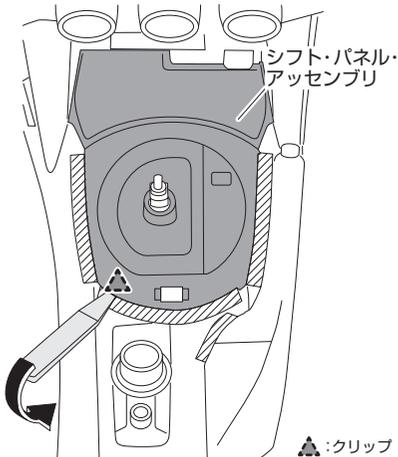
**4-6.** 図に示す矢印の方向にリムーバ・ツールを動かし、フック①、②の順にかん合を外す
