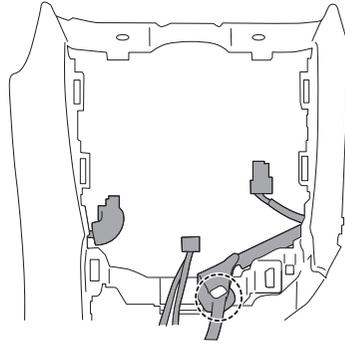
**7-3.** 図に示す網掛け部を持ち、矢印①、②の順にリヤ・コンソールを持上げ、クリップのかん合を外す
