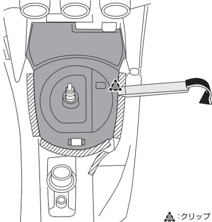
**4-5.** 図に示す矢印の方向にリムーバ・ツールを動かし、リヤ・コンソールとフックのかん合を外す
