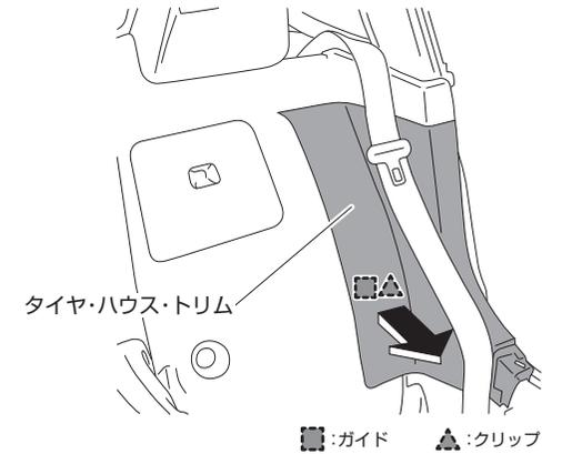
**9-4.** 図に示す矢印の方向にタイヤ・ハウス・トリムをスライドさせながら取り外す
