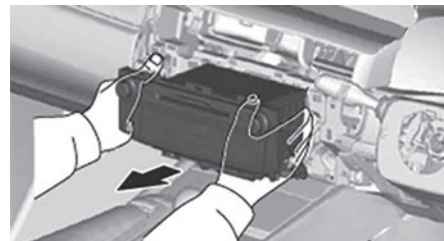
ツメとクリップを浮かせ、マルチメディアモジュールレシーバーを取り外します。
