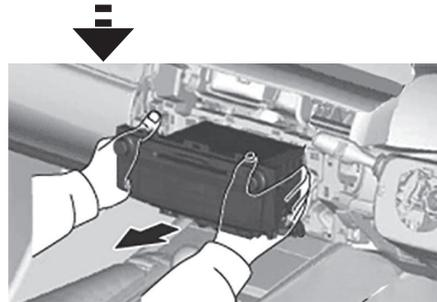
ツメとクリップを浮かせ、マルチメディアモジュールレシーバーを取り外します。
