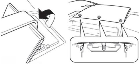
リムーバーを手前に引き上げ、ツメ(5か所)を外し、スピーカーカバーを浮かせます。
