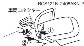
5. 「4.」で外した車両側のコネクターにRCA042Nのコネクターを接続します。
