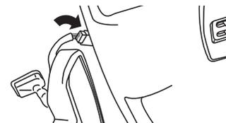
7. 接続概要図を参照して、本製品のRCAケーブルをヘッドライニング、Aピラーに沿って引き回し、ナビゲーション裏まで通します。
