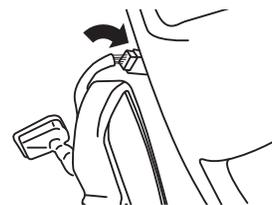
7. 接続概要図を参照して、付属のRCAケーブルをヘッドライニング、Aピラーに沿って引き直し、RCH001Tを介してナビゲーションへ接続します。
