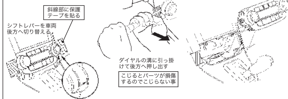
図3 エアコン操作パネル外し
