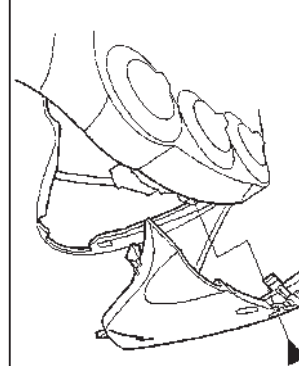
図1 アンダーパネル取り外し
