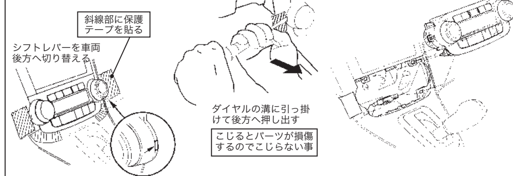
図3 エアコン操作パネル外し
