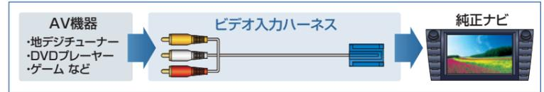
標準装備の外部入力端子を使わずにAV機器を増設ビデオ入力端子を装着すれば、車輻に標準装備されている外部入力端子を使用することなく、様々なAV機器をすっきりとした見た目でご利用いただけます。\*詳細は最新適合表をご確認ください。
