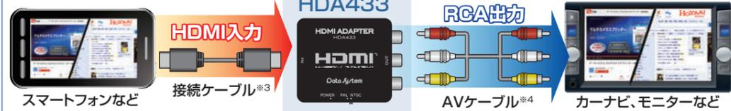
\*1:接続機器、映像ソース、アプリによっては、正しく表示されなかったり、小さな文字がしんて読みにくくなったりする場合があります。\*2:HDMI映像信号はHDCP対応、HDMI 1.3対応。3D映像は非対応です。\*3:スマートフォン等、端末に装着されているコネクタの種類によって本製品の品番や接続方法が異なります。詳しくは、接続機器をご参照ください。\*4:AVケーブルは別途ご用意ください。純正カーナビでAV入力端子がない場合、当社製品「ビデオ入力ケーブル」を別途ご用意頂くことで接続できるようになります。(一部ナビを除く)
